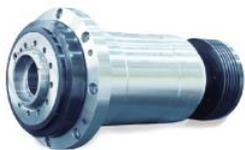
套筒式整体主轴, A2-8鼻端, 通孔 $\phi 80$ ; 过棒料直径 $\phi 66$
