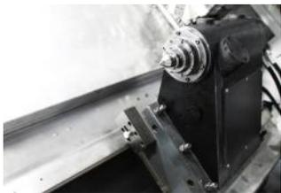
T2/1000规格可选配尾座导轨硬轨结构。尾座为分体式套筒结构。
